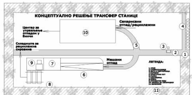
Слика 6.22. Ситуација концептуалног решења трансфер станице
