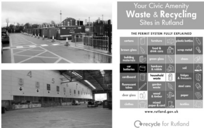
Слика 6.12. Пример отвореног и покривеног рециклажног дворишта у Енглеској и табле са приказом врста отпада које се прихватају у рециклажном дворишту
