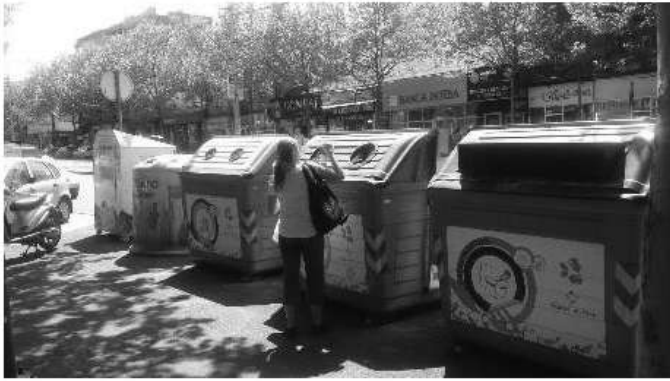
Слика 6.13. Пример „зеленог острва” у Београду са посу- дама од 3,2 м 3 за одвојено сакупљање папира, метала и пластике, и звонастог контејнера за сакупљање стакла
