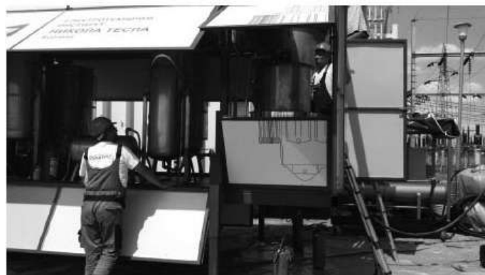
Слика 4.6. Мобилно постројење за деконтаминацију РСВ
